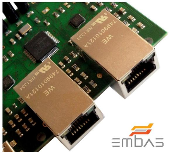
Ein auf einem XMOS 500 MIPS Prozessor basierendes Embedded Intrusion Detection / Protection System (IDS/IPS)
